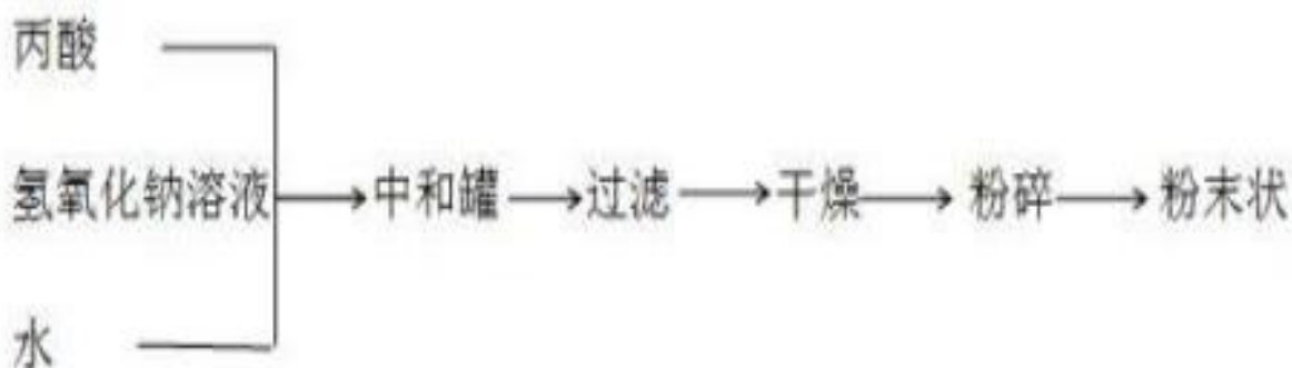
图 4-6 丙酸钠流程图
