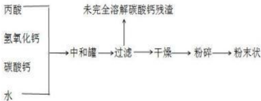
图 4-5 丙酸钙流程图
